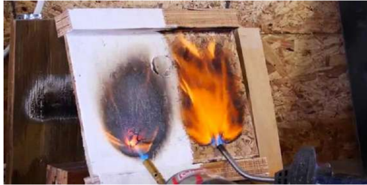
Gambar 5.57 Ilustrasi uji bakar kayu dengan coating anti api (kiri) dan kayu tanpa coating anti api)
