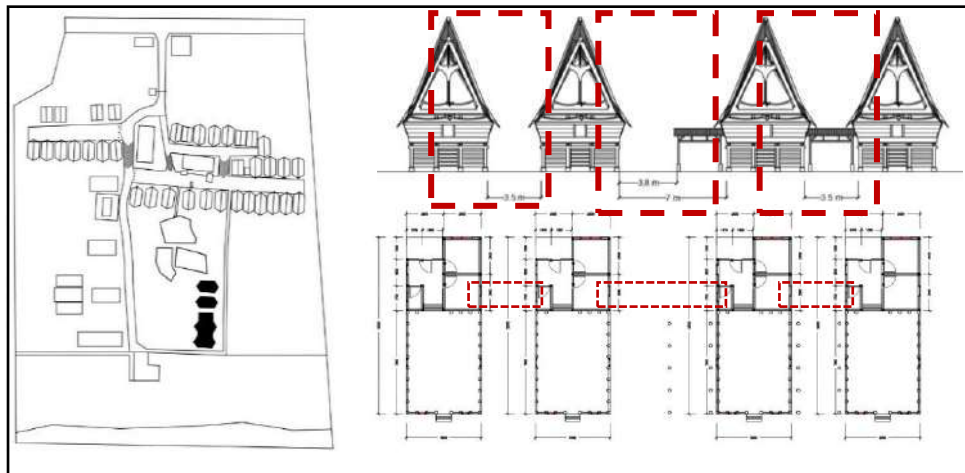
Gambar 5.8 Analisa jarak antar bangunan blok massa Barat
